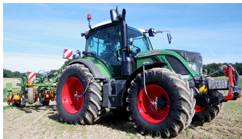
[Figure 7] Des systèmes de régulation de la pression des pneus et des outils trainés permettent de répartir de manière optimale le poids de la machine utilisée sur la surface du sol.
