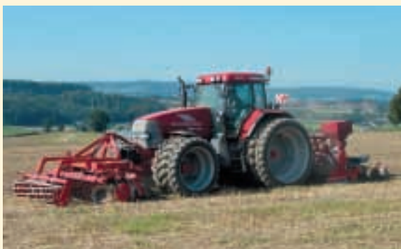
Utilisation de roues multiples et de semis sous litière.
