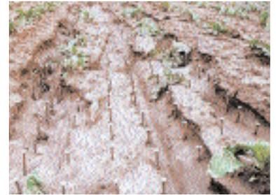
Des clous enfoncés préalablement dans le sol permettent de mesurer véritablement les conséquences de l'érosion. [4].
