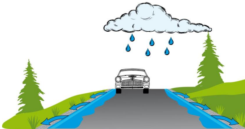
Abbildung 3: Strassenentwässerung über die Schulter.
