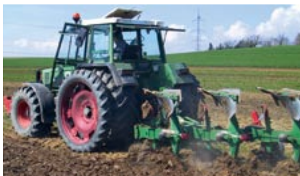
Abb. 13 Einsatz des On-land-Pfluges.
