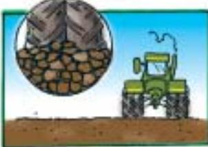
Grosszügige Bereifung, Doppelräder auch beim Anhänger. Reifendruck minimieren (0,8 bar).
