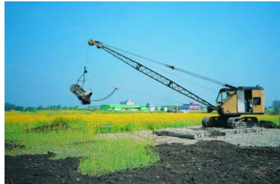
Die sorgfältige Rekultivierung mit geeigneten Maschinen wie Hydraulikbagger, Moorraupe oder Seilbagger (Bild) und Zwischenbegrünung ist aufwändig. Dies verpflichtet zu einer bodenschonenden Folgebewirtschaftung.
