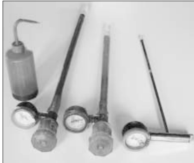
Abb. 47: Manometer-Tensiometer verschiedener Baulängen/-arten und Zubehör.
