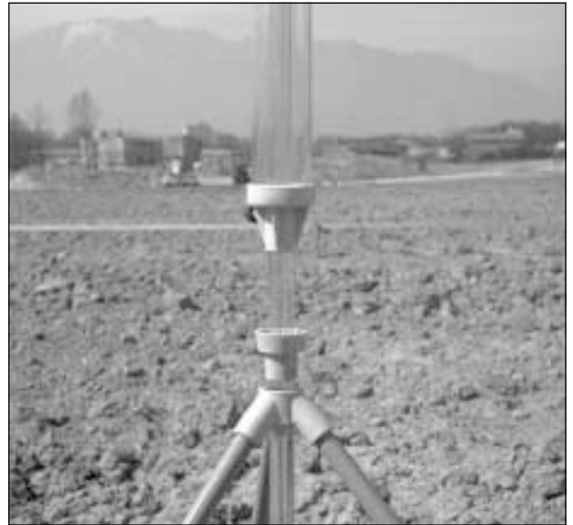
Abb. 45: Kontrolle der Wasserdurchlässigkeit einer grossen Geländeaufschüttung anlässlich einer Feldkampagne des IATE/EPFL (Al Carcale, 1994) bei Gordola (TI).
