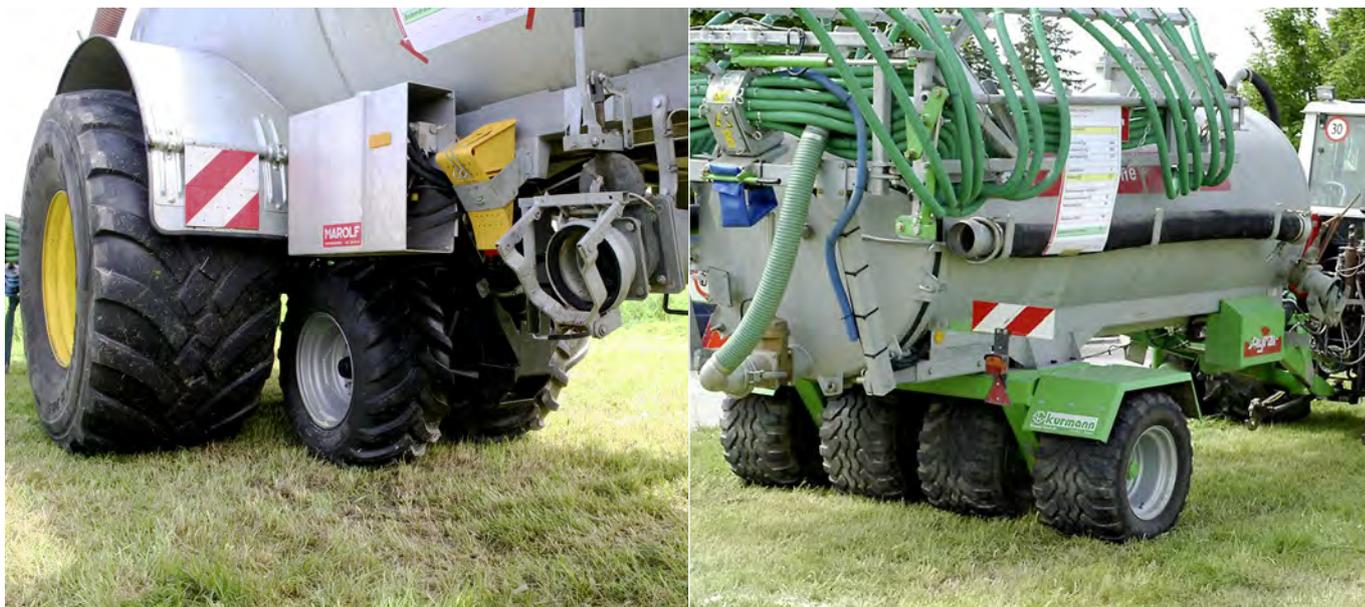
**Abbildung 2-5:** Mit innovativ umgerüsteten Fahrwerken (links: hydraulisch verstellbare Liftachse, rechts: Doppelpendelachse) wird das Gewicht von Güllefässern gleichmässig auf den Boden verteilt, was zu einem geringeren Bodendruck und damit zu einem schonenderen Befahren führt (1. Berner Bodentag am 28. Mai 2010, INFORAMA Rütli in Zollikofen).
