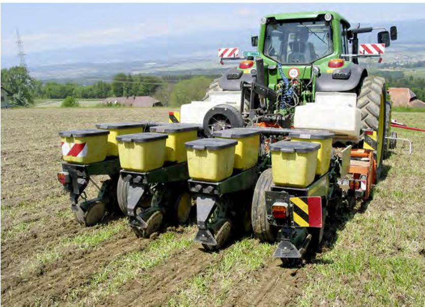
**Abbildung 3-4:** *Streifenfräsaat* von Mais in eine überwinternde Zwischenfruttermischung, welche mit einer max. Wirkstoffmenge von 1.5 l ha<sup>-1</sup> Glyphosat reguliert wurde. Im Jahr 2015 wurden schweizweit 7854 ha mit der Technik *Streifensa*at und 8796 ha mit der Technik *Direktsaat* angebaut (WYss 2016).
