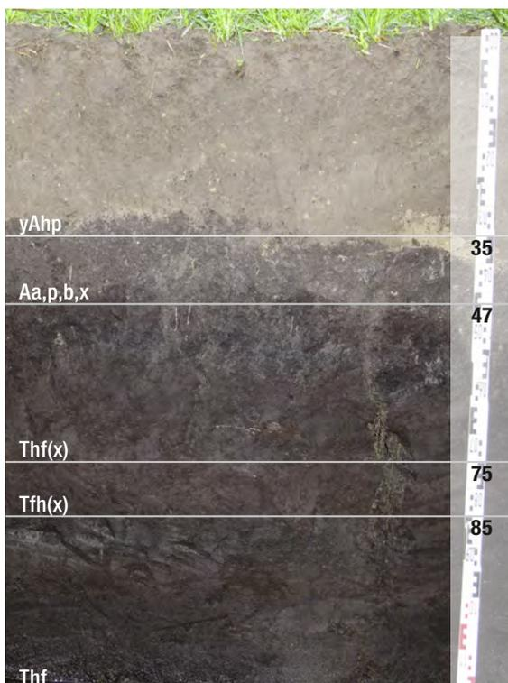
0–35 cm: yAhp – schwach humoser Bearbeitungshorizont (= Sanddeckschicht); Subpolyeder-, Einzelkorn- und Krümelgefüge; 14 % Ton, 10 % Schluff, 76 % Sand – 5.2 % Humus – pH 7.6
