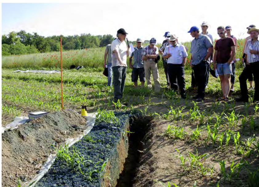
**Abbildung 2-6:** Die Demonstration einer Farbinfiltration am Miniprofil veranschaulicht Bodenverdichtungen unter Fahrspuren (3. Berner Bodentag und 3. Schweizer Bio-Ackerbautag am 12. Juni 2014, Bio-Schwand in Münsingen).
