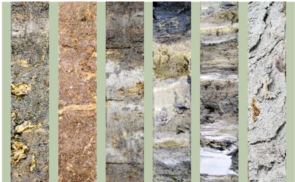
**Abbildung 7-12:** Bohrungen bringen es an den Tag: Während ihrer Entstehung haben sich im *Gürbetal* bis zu 3.5 m mächtige, locker gelagerte Torfschichten mit kaum konsolidierten Seesedimenten verzahnt.
