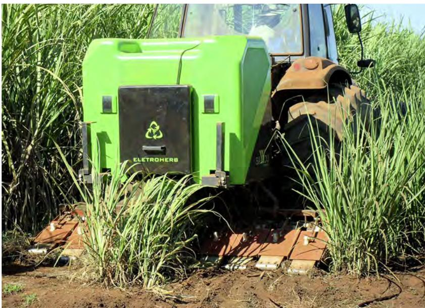
Abbildung 4-12: Eine neue Technologie aus Brasilien, basierend auf Elektrizität, soll in Zukunft die Unkrautbekämpfung mit Herbizidverzicht – namentlich ohne Glyphosat – ermöglichen.
