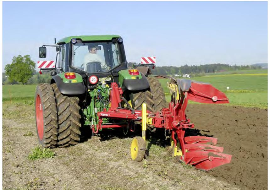
**Abbildung 3-5:** *On Land-Pflug* bei abgetrockneten Bodenverhältnissen: Alle Traktorräder – hinten doppelt bereift – laufen bei dieser Technik auf der unbearbeiteten, biologisch verbauten und damit tragfähigen Bodenoberfläche.
