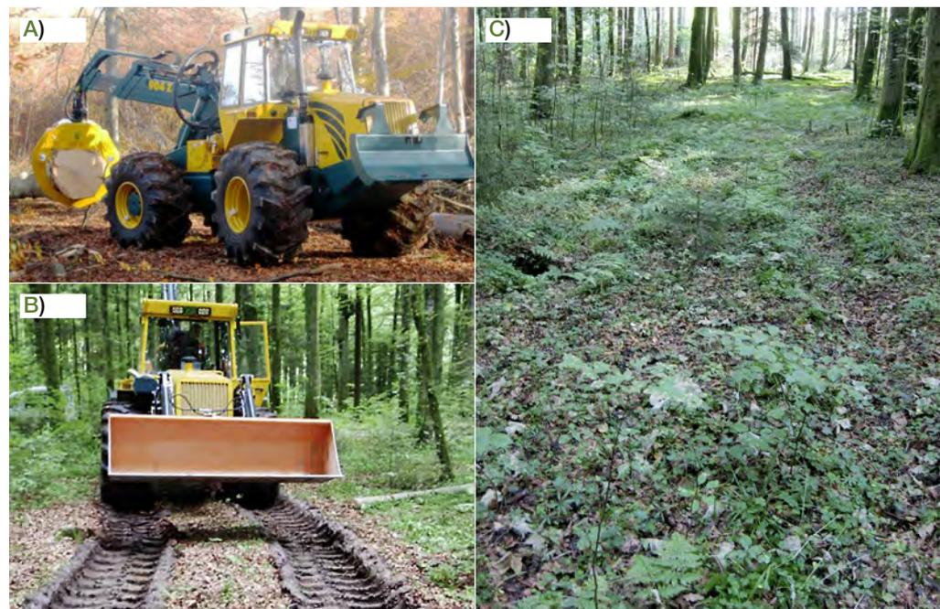
**Abbildung 9-3:** (A) und (B) Befahrungsversuch mit der Forstmaschine HSM 805 D (ohne Last 14 t) in Heitere-Säget im Kanton Bern. (C) Die Situation acht Jahre nach dem Befahren: Durch die natürliche Regeneration (wechselfeuchte Bedingungen, Frostzyklen, Regenwurmaktivität, Wurzelwachstum etc.) hat sich die Bodenqualität in den verdichteten Fahrspuren stark verbessert.
