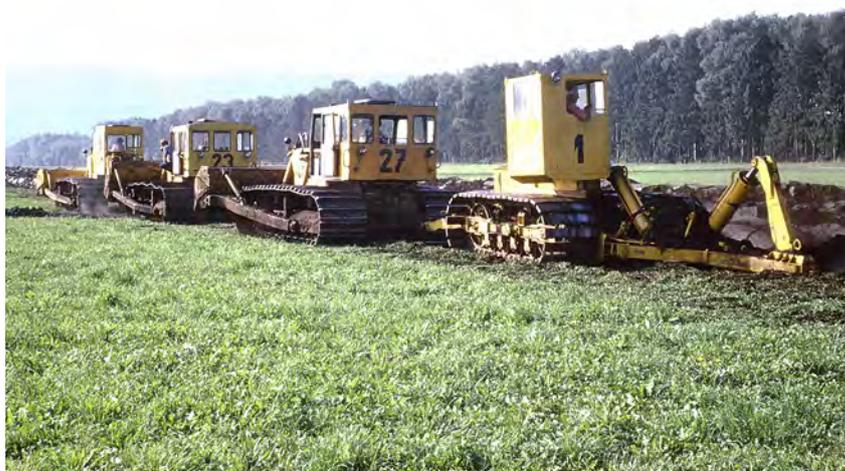
**Abbildung 7-7: Tiefpflug:** Der Fahrer im hintersten Raupenfahrzeug reguliert während dem Einsatz die Arbeitstiefe des Pflugs (Mischverhältnis: ein Volumenteil organischer Torf und ein Volumenteil mineralischer Untergrund).
