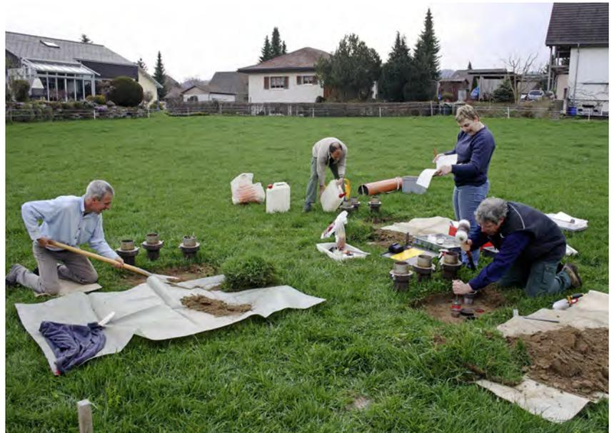
**Abbildung 3-2:** Beprobung des KABO-Standortes in Madiswil (BE) am 3. April 2012: Jeweils im Frühjahr des 2. Hauptnutzungsjahres der Kunstwiese erfolgt die Probenahme. Nach dem Ausheben einer Grube (links) werden die ungestörten Zylinderproben zur Bestimmung der Parameter *Lagerungsdichte*, *Luftdurchlässigkeit*, *Porenvolumen* und *Strukturstabilität* entnommen (rechts). Parallel dazu werden Infiltrationsmessungen vorbereitet (hinten).
