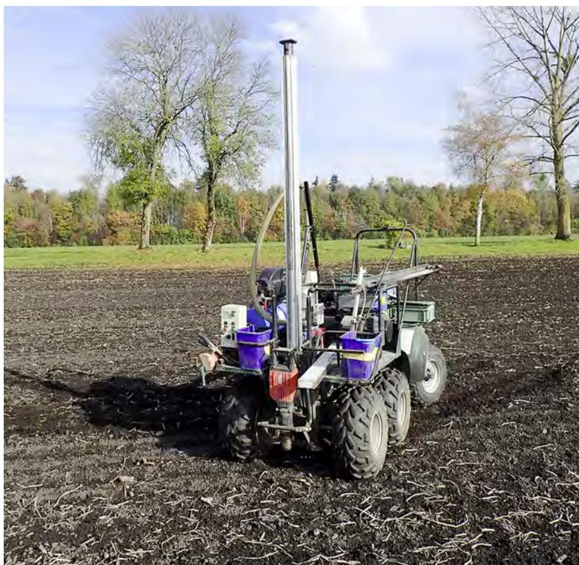
**Abbildung 6-6:** Zur Erleichterung und Beschleunigung der Feldarbeiten wurde ein Quad mit einer angetriebenen Bohreinrichtung ausgerüstet.
