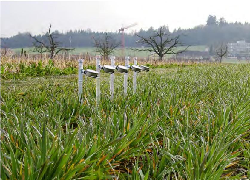
**Abbildung 10-1:** Tensiometermessstation mit Handablesung: Der Medianwert von jeweils fünf Tensiometern erfasst die Heterogenität des Bodens.
