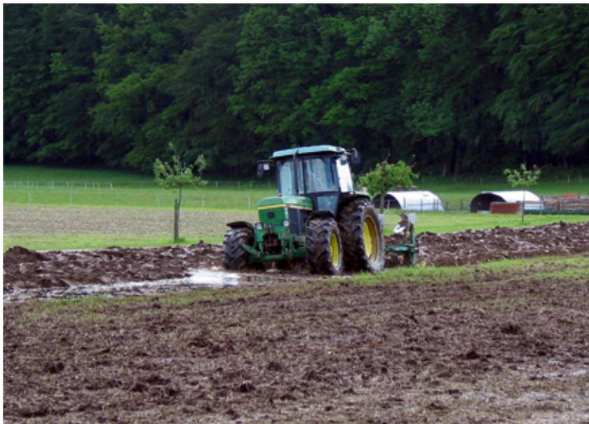
Abbildung 7–10: Konventioneller Pflugeinsatz. Bei dieser Pflugtechnik läuft je ein Schleppervorder- und –hinterrad auf dem Furchengrund, was eine Doppelbereifung verunmöglicht. Das Schleppergewicht wird einseitig abgestützt. Bei nassen Bodenbedingungen ist grosser Schlupf unabwendbar.
