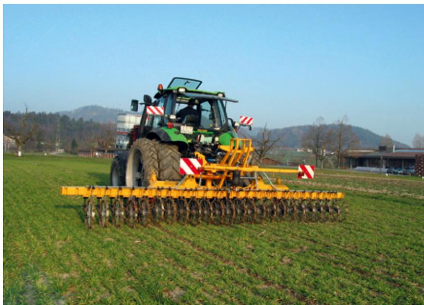
Abbildung 6–5: Stickstoff-Versorgung eines Getreidebestandes mit flüssigem Ammoniumsulfat mittels speziell konstruierter Radinjektoren
