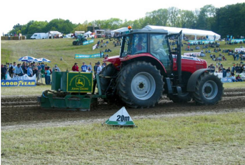
Abbildung 4-8: Bodenverdichtung im Pistenbereich eines Tractor Pulling-Wettkampfes durch Druckbeanspruchung und hohen Schlupf der Antriebsräder
