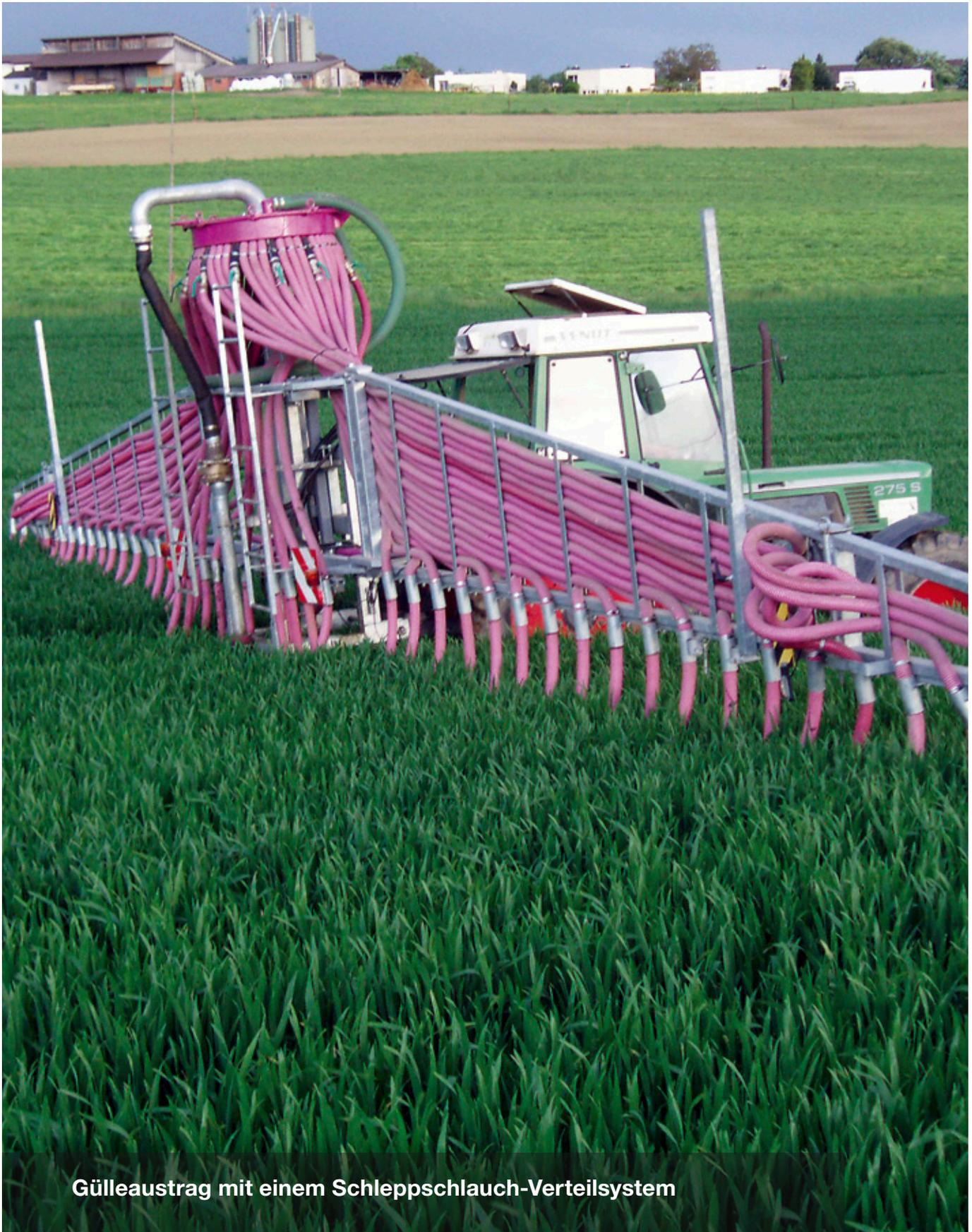
Gülleaustrag mit einem Schleppschlauch-Verteilsystem
