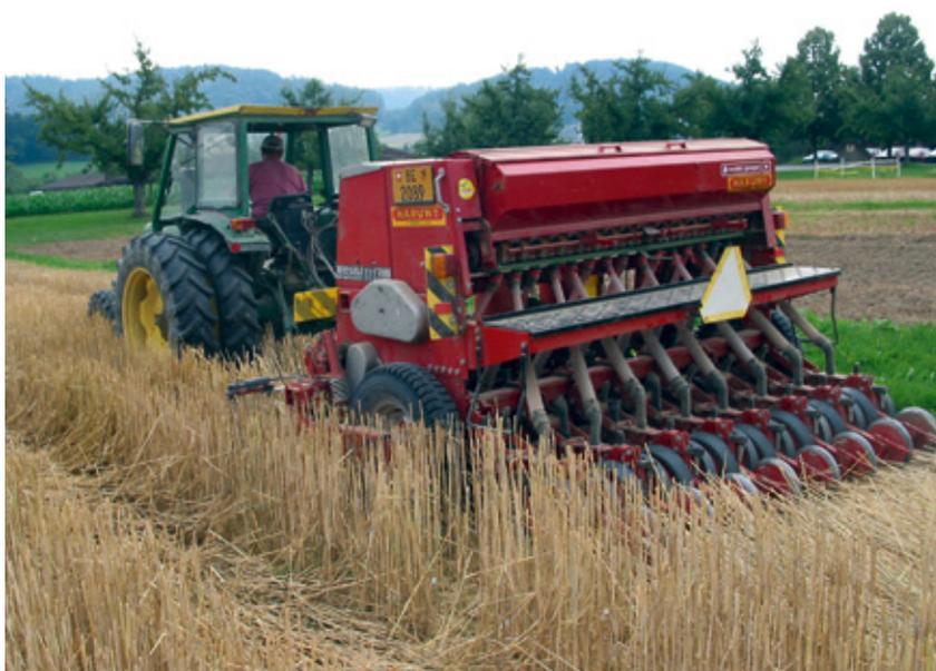
Abbildung 8–2: Die Direktsaat der Gründüngung erfolgt in das im Hochschnitt gedroschene, gleichmässig verteilte und noch brüchige Stroh des gleichentags geernteten Getreides.
