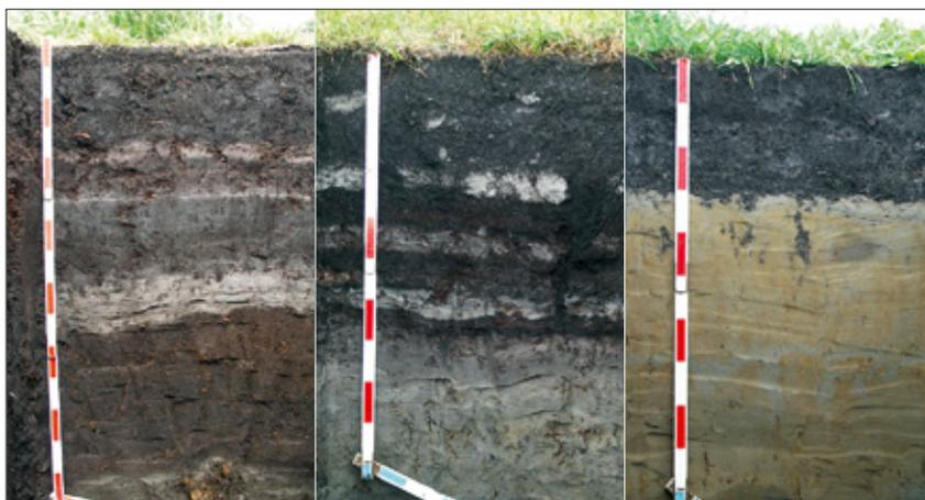
**Abbildung 3-3: Drei der fünf zur Quantifizierung des Kohlenstoffverlust 2006 ausgehobene Bodenprofile auf dem Areal der Anstalten Witzwil (von links: tief-torfartig auf Seekreide; flachtorfartig auf Seekreide und antorfartig auf Sanddüne)**
