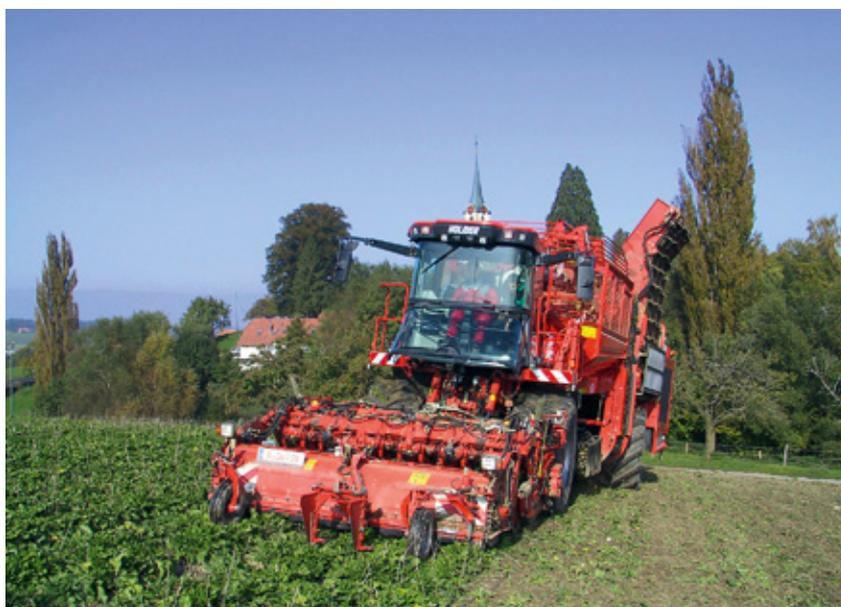
Abbildung 4-5: Sechsreihiger selbstfahrender Zuckerrübenvollernter
