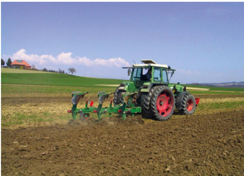
Abbildung 7–11: On Land-Pflugeinsatz. Alle, hinten doppelt bereiften, Schlepperräder laufen bei dieser Pflugtechnik auf der unbearbeiteten, noch biologisch verbauten und abgetrockneten Bodenoberfläche.
