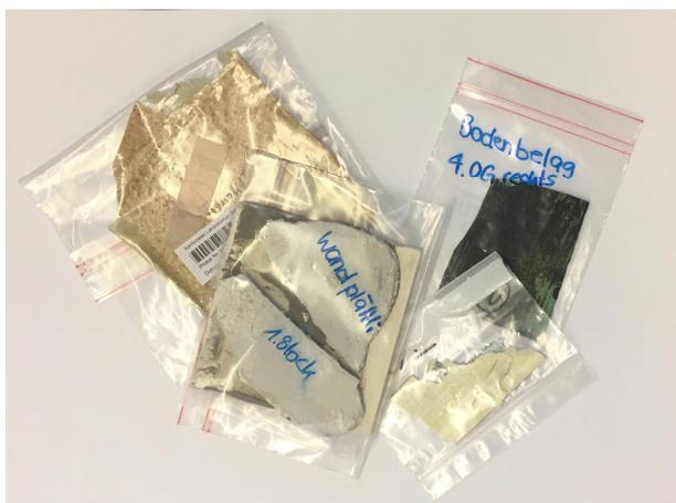
**Juste:** Chaque type de matériau est emballé séparément et est étiqueté de manière univoque (p. ex. revêtement de sol 4<sup>ème</sup> étage droite et panneaux muraux 1<sup>er</sup> étage).
