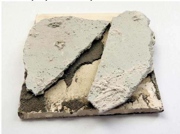
**Carreau (en-dessous) avec deux sortes de colle** (ici gris foncé et gris clair): prélever un échantillon de la taille de la paume de la main, avec toutes les couches de colle (idéalement jusqu'à la brique, resp. jusqu'au mur porteur).
