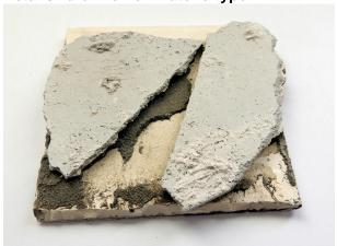
Fliese (unten) mit zwei Sorten Kleber (hier dunkel- und hellgrau): Handtellergrosse Probe entnehmen mit allen Schichten des Klebers (im Idealfall bis auf Backstein, bzw. tragende Wand). Untersucht werden die Schichten als Mischprobe oder auf Wunsch als einzelne Proben.
