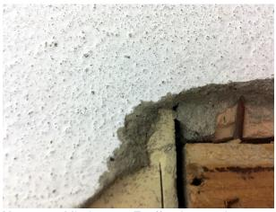
**Verputze**: Mindestens Fünffrankenstück grosse Probe entnehmen mit allen Schichten bis auf tragende Wand. Entnahmestelle anschliessend mit Klebeband abdecken.
