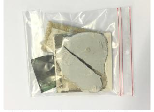
Falsch: Mischproben. Das Beispiel oben zeigt unterschiedliche Materialien, die in einen Beutel verpackt worden sind. Aufgrund gegenseitiger Kontamination ist keine aussagekräftige Analyse der Einzelproben mehr möglich!
