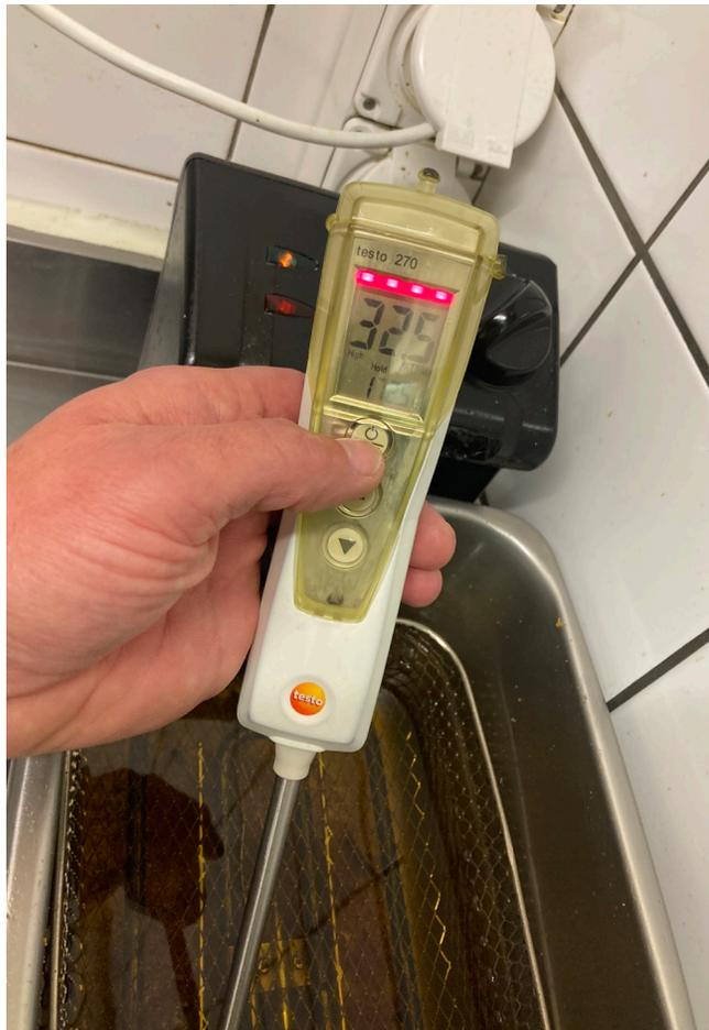
Abb. 21 Qualitätsüberprüfung eines Frittieröls.
