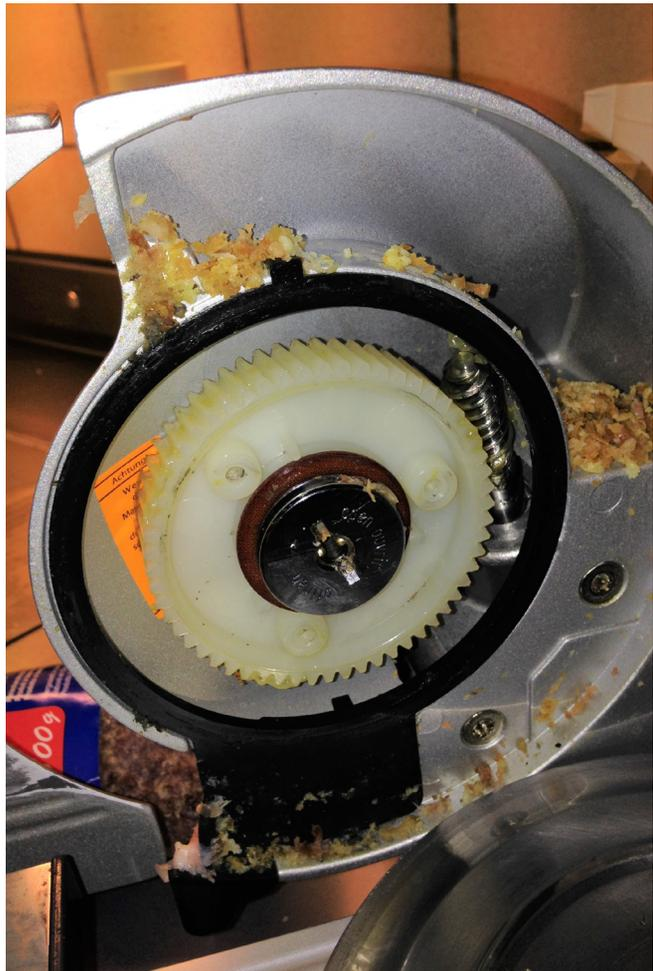
Abb. 4 Aufschnittmaschine aus einem Verpflegungsbetrieb, die zum Reinigen noch nie zerlegt worden war.
