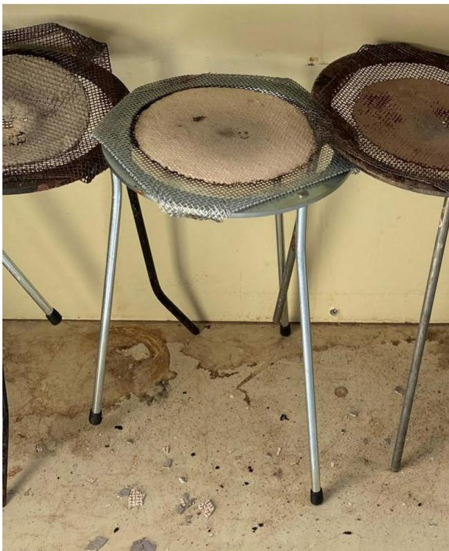
Abb. 25 Drahtnetze mit asbesthaltiger Beschichtung.
