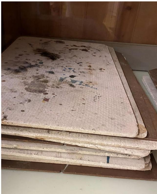
Abb. 26 Feuerfeste Unterlagen aus asbesthaltigem Material.
