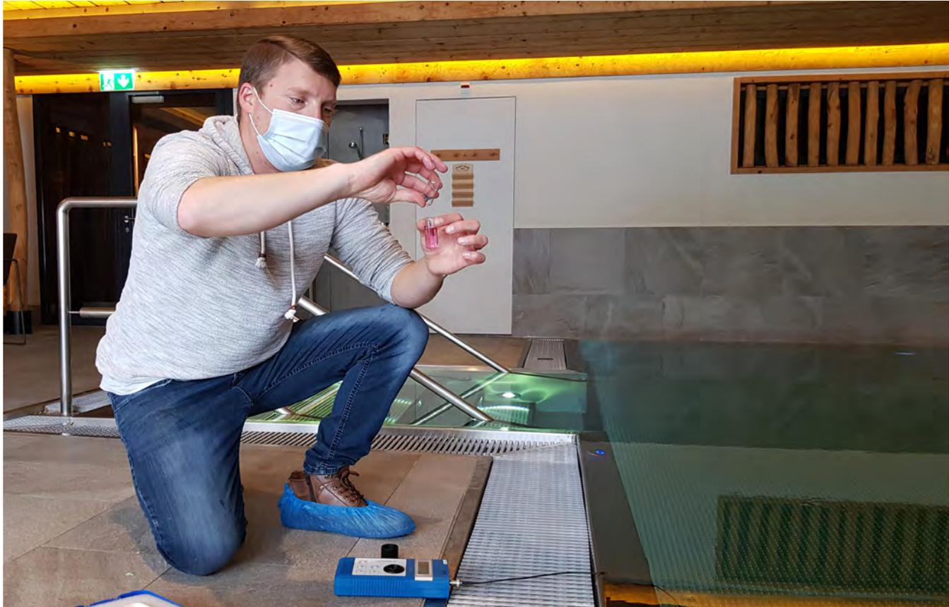
Abb. 20 Technischer Inspektor bei der Überprüfung des Chlor-Gehalts in einem Hotelbad.
