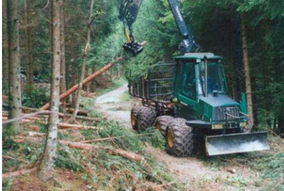
*Le transporteur : un engin moderne utilisé pour la vidange des bois (utilisé ici en combinaison avec le cheval).*
