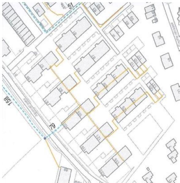
III. 3 : Conduites de raccordement (jaune) pour un ou plusieurs immeubles avec des conduites d'une longueur supérieure à 100 m sur plusieurs parcelles. Si les conduites de gaz sont réalisées en même temps que la construction du bâtiment, il faut viser une procédure coordonnée (cf. chiffre 1.4). L'OEE fait appel à l'ITIGS pour la procédure d'octroi de permis de construire de conduites de gaz d'une pression supérieure à 1 et inférieure ou égale à 5 bars.
