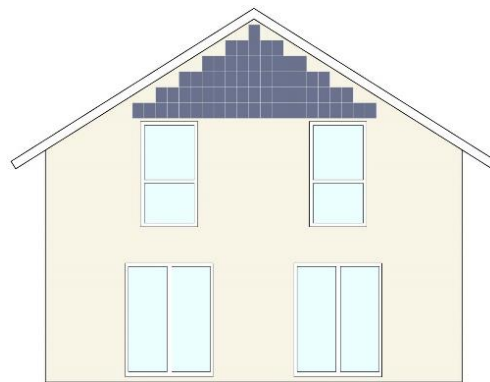
III. 28 Les modules de l'installation sont posés en escalier et ne recouvrent pas entièrement le pignon concerné.
