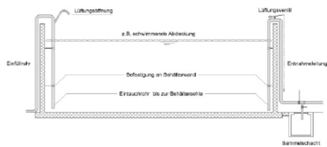
Abb. 21 > Befüllen und Absaugen unterhalb der Gülleoberfläche
