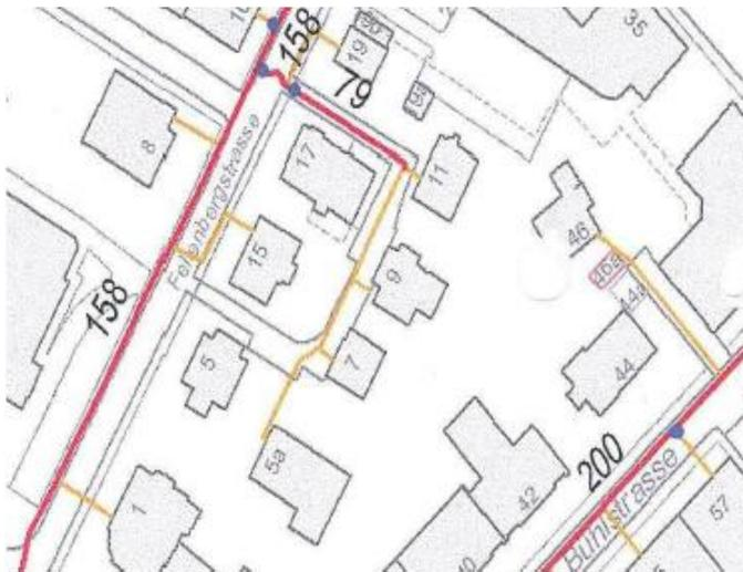
Abb. 1: Diverse Hausanschlüsse (Anschlussleitungen / gemeinsame Anschlussleitungen, gelb), ab bestehender Versorgungsleitung (rot) mit einer Länge < 100 m. Beim Bau solcher Hauszuleitungen ist nur die Zustimmung der Grundeigentümer (inkl. Strasseneigentümer) erforderlich. Bei Gasleitungen > 1 und ≤ 5 bar zieht der Gasbetreiber in der Planung und bei der Abnahme das TISG bei.
