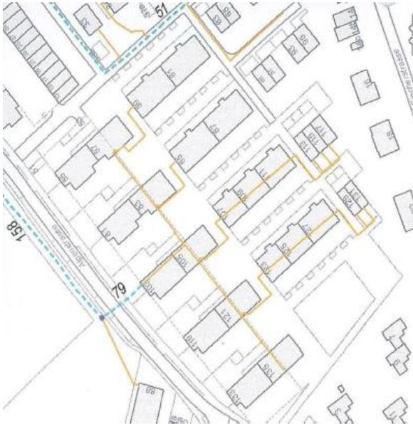
Abb. 3: Anschlussleitungen (gelb) für eine oder mehrere Liegenschaften mit Leitungslängen von mehr als 100 m über mehrere Parzellen. Sofern die Gasleitungen gleichzeitig mit dem Bau der Gebäude erstellt werden, ist ein koordiniertes Verfahren anzustreben (siehe Ziffer 1.4). Das AUE zieht im Rahmen des Baubewilligungsverfahrens für Gasleitungen > 1 und ≤ 5 bar das TISG bei.
