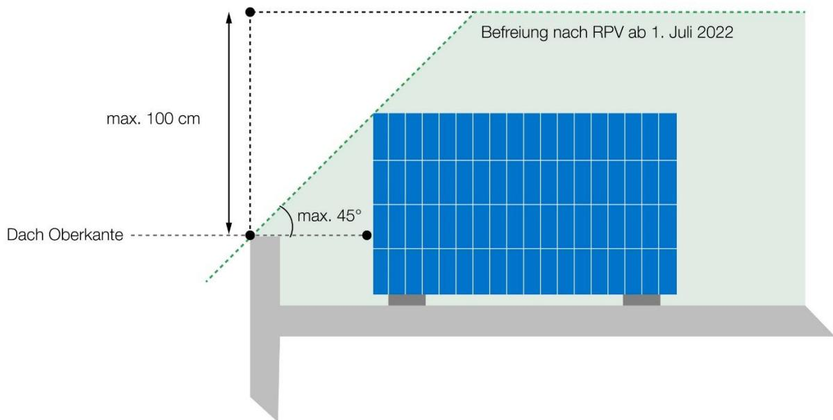
Die Grafik visualisiert die ab 1. Juli 2022 geltende Auslegung für die baubewilligungsfreie Installation einer Solaranlage auf einem Flachdach nach der Raumplanungsverordnung. Für solche Modulanordnungen ist das Meldeverfahren zulässig.
