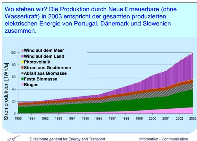
Abbildung 20: Entwicklung der Elektrizitätserzeugung aus Neuen erneuerbaren Energien in der EU, ohne Wasserkraft (Quelle: Europäische Kommission, Karl Kellner)
