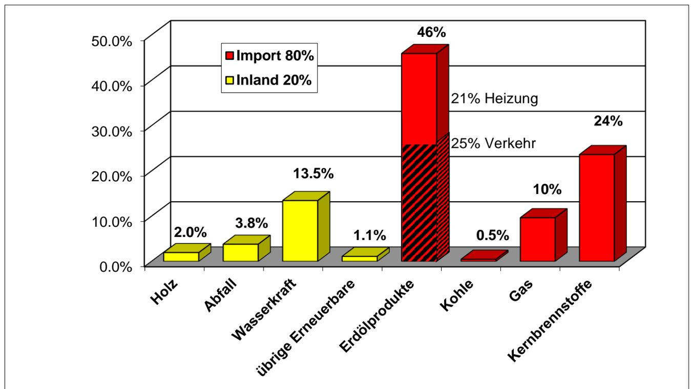
Abbildung 1: Energiebereitstellung (gesamtschweizerische Angaben inklusive Verkehr und stationäre Energienutzung, 2004)
