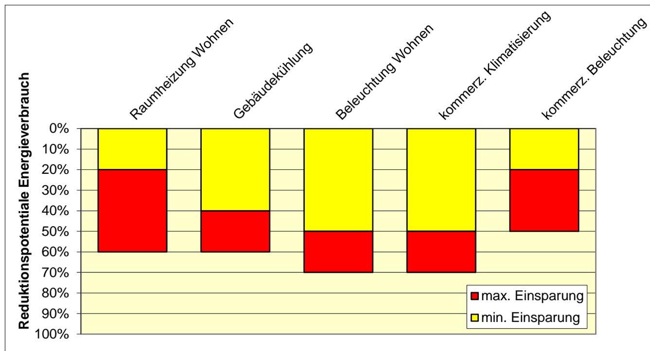
Abbildung 15: Energiesparpotenziale durch bessere Energieeffizienz bei den heutigen Bauten mit aktuell besten Techniken gemäss IEA.
