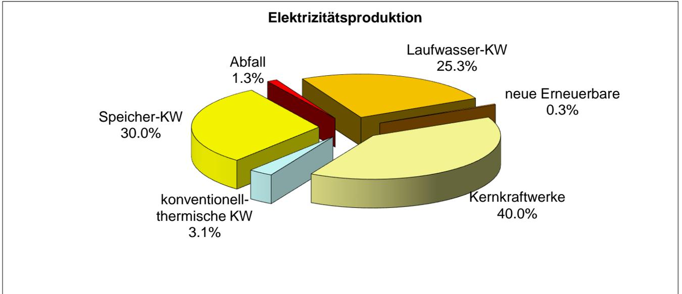
Abbildung 10: Aufteilung der Elektrizitätsproduktion nach Technologien (gesamtschweizerisch 2004)
