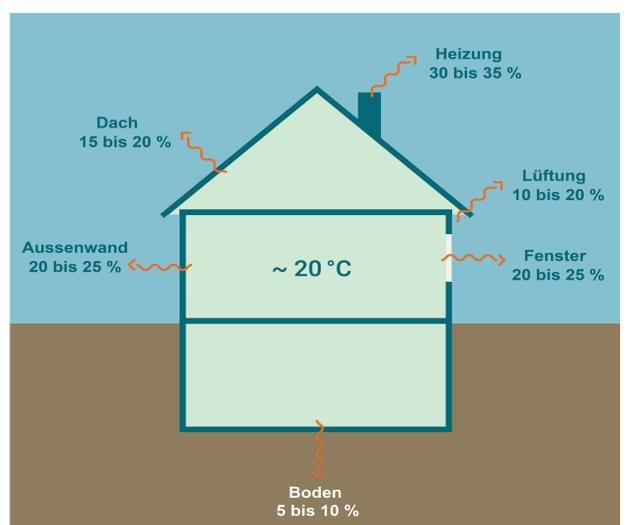
Energetisches Sanieren spart Energie. **Beispiel Dach:** Dort sparen Sie ca. 15 bis 20 % Energie.
